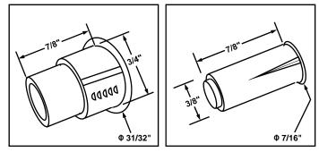
FIG. 4A: INSERT DOOR CONTACT (MAGNET) IN JAMB
