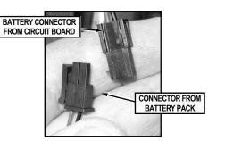
FIG. 17: CONNECT THE BATTERY PACK
