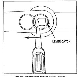
FIG. 23: REMOVING THE IC CORE LEVER
