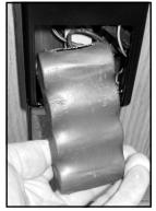
FIG. 18: INSERT BATTERY PACK INTO HOUSING
