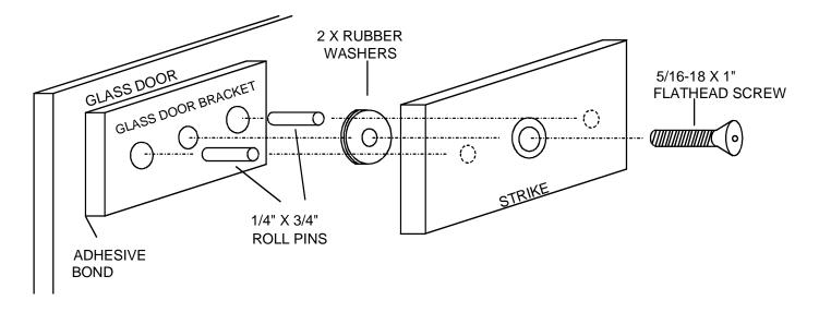
BE SURE THAT BRACKET IS POSITIONED CORRECTLY BEFORE GLUING BE SURE THAT FLY CUT SIDE OF BRACKET FACES GLASS
