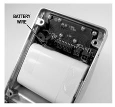
FIG. 14: INSTALL BATTERY PACK FLUSH WITH BACK OF LOCK
