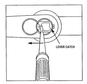
FIG. 21: REMOVING THE IC CORE LEVER
